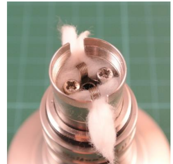
Pic 8: Die Kammerhülse wird nun vorsichtig nach oben gezogen. Die Watte nun ggf. noch etwas verteilen, so dass diese immer noch locker sitzt.
